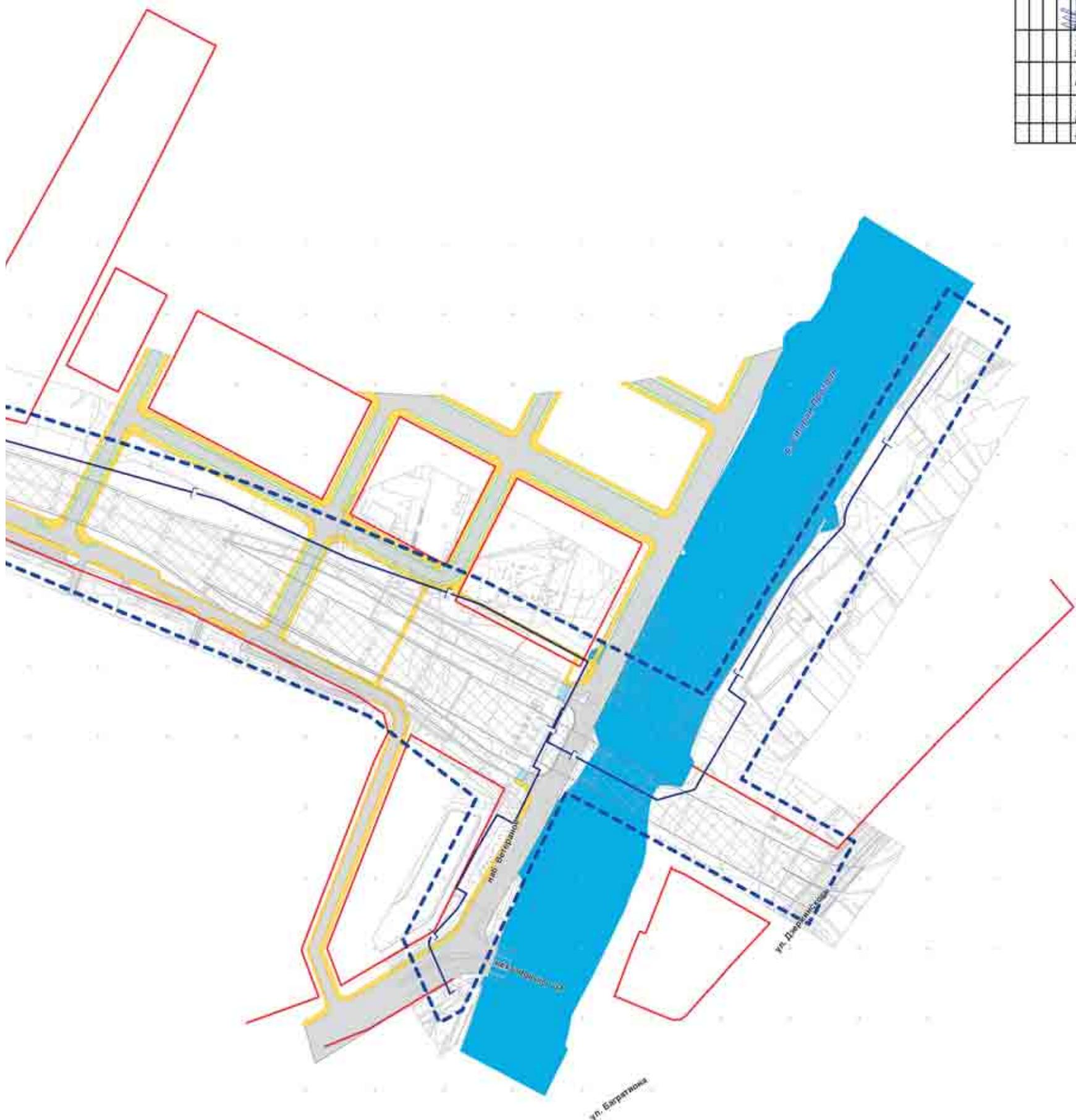
Чертеж размещения площадок для складирования материалов и техники на период строительства линейного объекта
